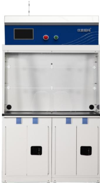
怎样高效的使用实验室通风柜？即使在具有特殊通风柜设计的设备中，只有在有效使用设备的情况下才能实现高效率。遵循正确的操作程序是关键。每种类型的通风柜都有自己的一套制造商的说明和程序。但是，良好的实验室通风柜程序的例子通常包括以下内容：当通风柜内部有大型设备时，将架子放在设备下方，以便空气可以在其下方流动。除非在调试设备或在通风柜中工作时，始终保持通风柜关闭。将任何容器或设备放在距离通风柜面6英寸或更远的地方。为了较大幅度地提高性能，请尽可能保持通风柜窗扇关闭。如果发生停电，请将通风柜窗扇降低到1英寸以内。允许一些空气继续流入通风柜，以此来产生烟囱效应。特别注意如纸制品，化学擦拭巾和铝箔。诸如这些的轻质材料很容易被吸入排气口，阻碍气流。如果使用台式通风柜，请使用滑动窗扇屏障。它可以保护你，让你的脸部保持在工作区域外。
